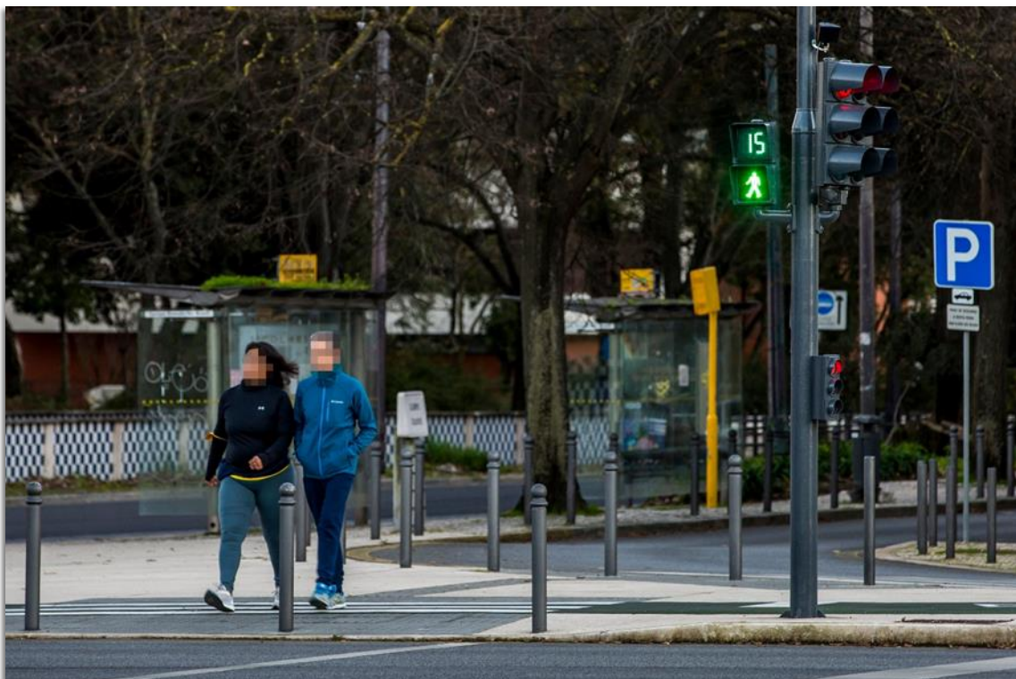
Figura 3.6 Passagem de peões semaforizada e com contador de tempo
